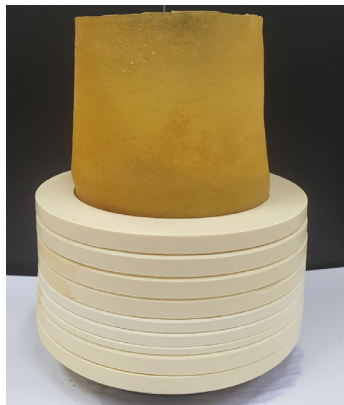
(d) Shear ring installation
