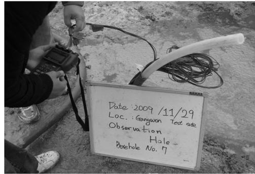
그림 10. 지반 온도 측정 모습
