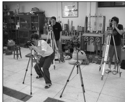
그림 6. 모형시험 장치의 거동 전·후 변화량 측정모습
